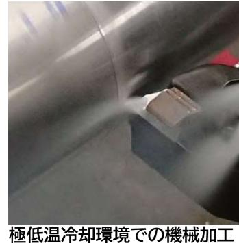
極低温冷却環境での機械加工
