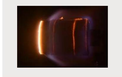
アーク加熱風洞での大気再突入模擬実験
