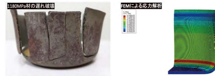
自動車用超高張力鋼遅れ破壊品の応力解析
